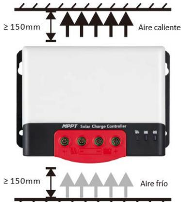
Fig 5. Instalación y disipación del calor
