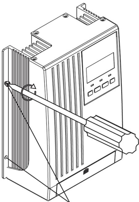
Inserte los tornillos a través de los agujeros del chasis posterior para poder sujetar el regulador a la pared
