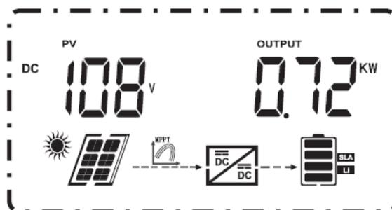
Cuando conectamos los paneles solares, el voltaje de entrada nos muestra la tensión en el campo fotovoltaico. A la derecha nos aparece la potencia de paneles. Si pulsamos los botones up y down podremos ir viendo distintas unidades de medida de la instalación solar, como la tensión en baterías y la intensidad entrante en Ah. Podremos ver también como en el esquema inferior aparece el flujo de energía desde paneles hasta baterías.
